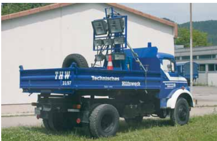
Einen 1981 gebauten Mercedes 1113 Kipper hat man in Bad Säckingen zu einem ungewöhnlichen Beleuchtungsfahrzeug umgebaut. Auf der Pritsche wurde im Winter 1999/2000 eine hydraulische Montagebühne installiert. Diese lässt sich auf 12 Meter Gesamthöhe ausfahren, die Scheinwerfer leisten zusammen 26.000 Watt. Verlastet sind außerdem 250 Meter Verlängerungskabel (230 und 400 Volt), ein Reservereifen und Absperrmaterial. Das Fahrzeug läuft über die örtliche Gefahrenabwehr. Auffällig ist der Rundhauber vor allem durch sein Streifendesign am Fahrerhaus.
