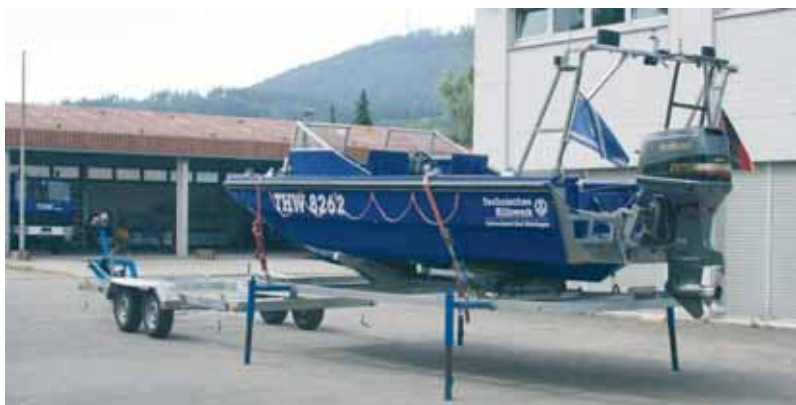
Der Trailer ist so konzipiert, dass das Rettungsboot auch separat auf Stützen abgestellt werden kann. Das Anhängerfahrzeug ist dann als Wechselladerfahrzeug auch für andere Transportaufgaben frei.
