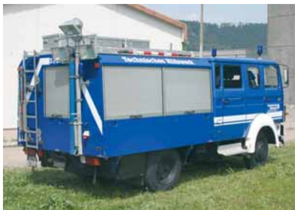
Dieser IVECO 90-16 AW gehört zur Fachgruppe Infrastruktur. Die Ausstattung ist sowohl im Kofferaufbau als auch in Aluboxen auf dem Dach verstaut. Am Heck befindet sich ein pneumatisch ausfahrbarer Lichtmast.
