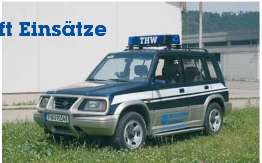
Für Einsatz- und Dienstfahrten wird dieser Suzuki Vitara Geländewagen eingesetzt. Aus Kostengründen wurde auf die Umlackierung verzichtet. Der dunkelblaue Japaner wurde dafür aber im THW-Look beschriftet sowie mit Funk und Blaulichtbalken ausgerüstet.
